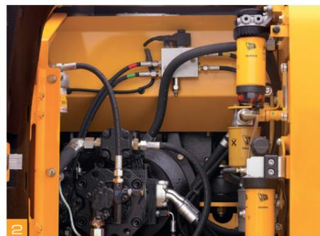
2 Os filtros em uma JS130 LC (óleo do motor, óleo hidráulico e combustível) estão localizados de maneira centralizada, tendo em vista uma manutenção mais rápida e fácil.
